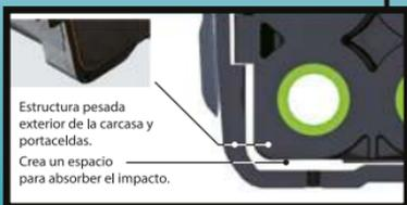
Estructura pesada exterior de la carcasa y portaceldas. Crea un espacio para absorber el impacto.
