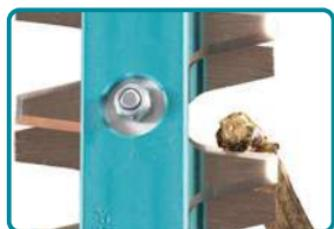
El protector de la punta, presente en ambos modelos, cuida a la cuchilla de un desgaste innecesario
